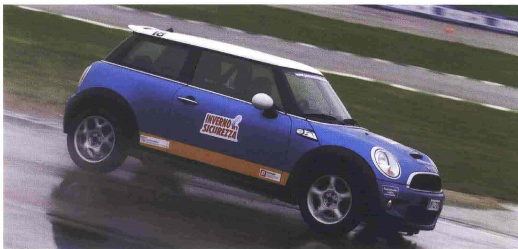
Sottoposto a diverse prove di frenata in rettilineo, in curva, direzionalità e tenuta di strada, il pneumatico invernale ha dimostrato tutta la sua superiorità in condizioni di basse temperature anche in assenza di neve sul manto stradale.
